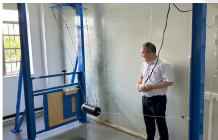
04. 磁力锁撞击测试 (通过美国ANSI标准铁锤撞击测试)
